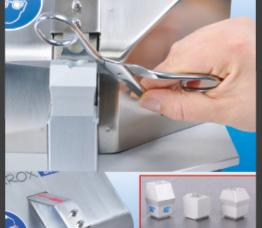
Schleifwinkel sehr einfach und schnell verstellbar!
